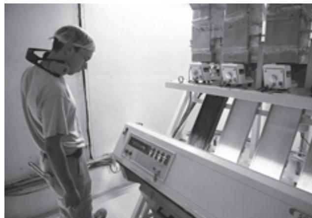
Depois de três processos de lavagem e branqueamento do arroz, chega a “cereja no topo do bolo”. A selectora de cor. Processa cinco toneladas de arroz / hora a uma velocidade estonteante e rejeita todos os bagos que não forem do branco ideal.
