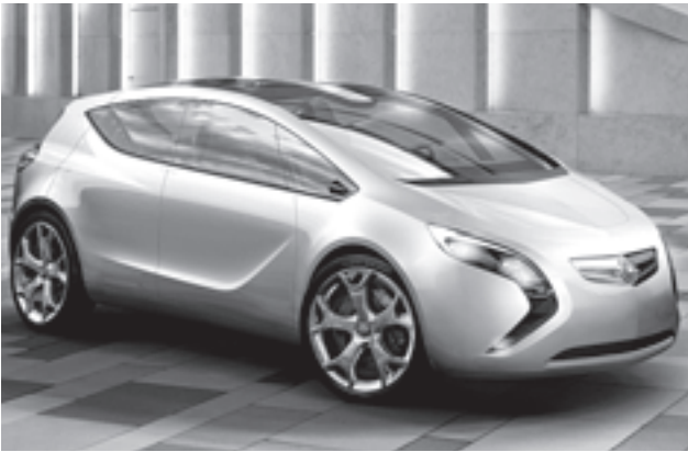
Opel Flextreame | Este é um ‘concept car’ da General Motors que recorre ao sistema de propulsão eléctrica “E-Flex”, permitindo uma autonomia de 65 quilómetros com uso exclusivo de electricidade. Os testes indicam que a emissão de CO2 ronda 40 gramas/km.
